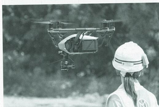
写真-3 測量用ドローン
